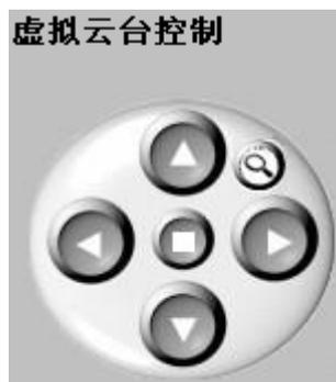
如上图所示区域有“放大镜”，以及上下左右停止5个按钮用于实现虚拟云台功能。
